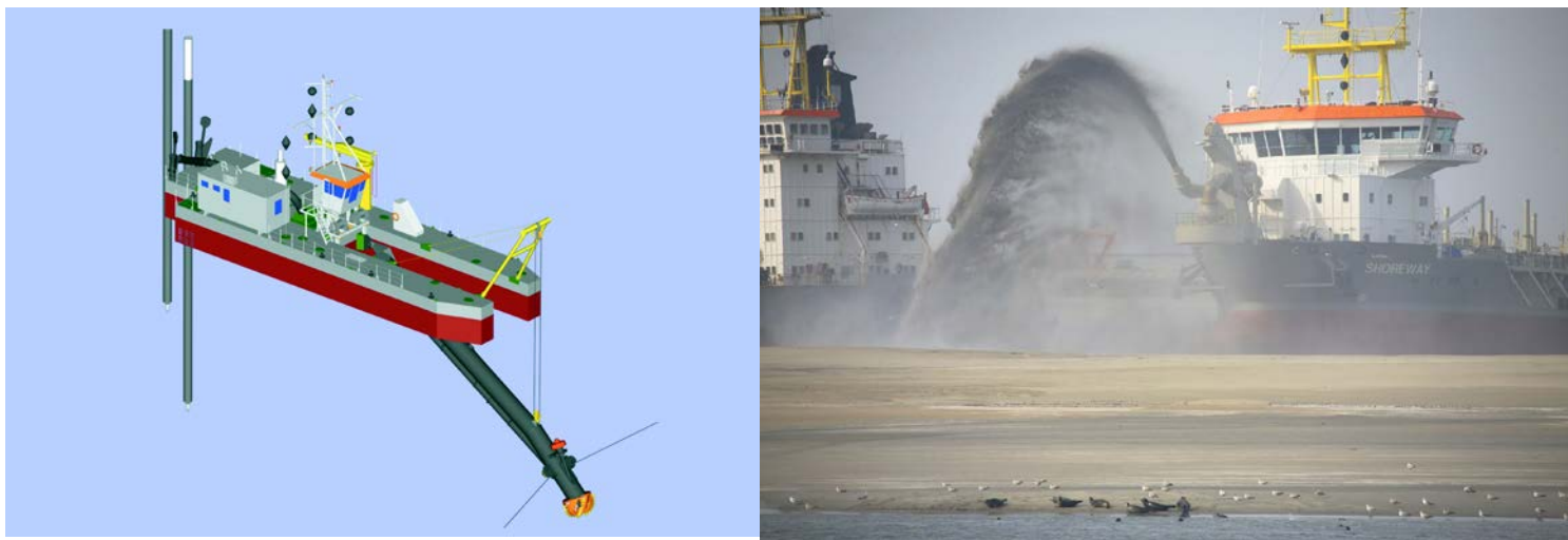
Fig. 5-6 Creazione di tratto di costa artificiale tramite navi aspira sabbia
