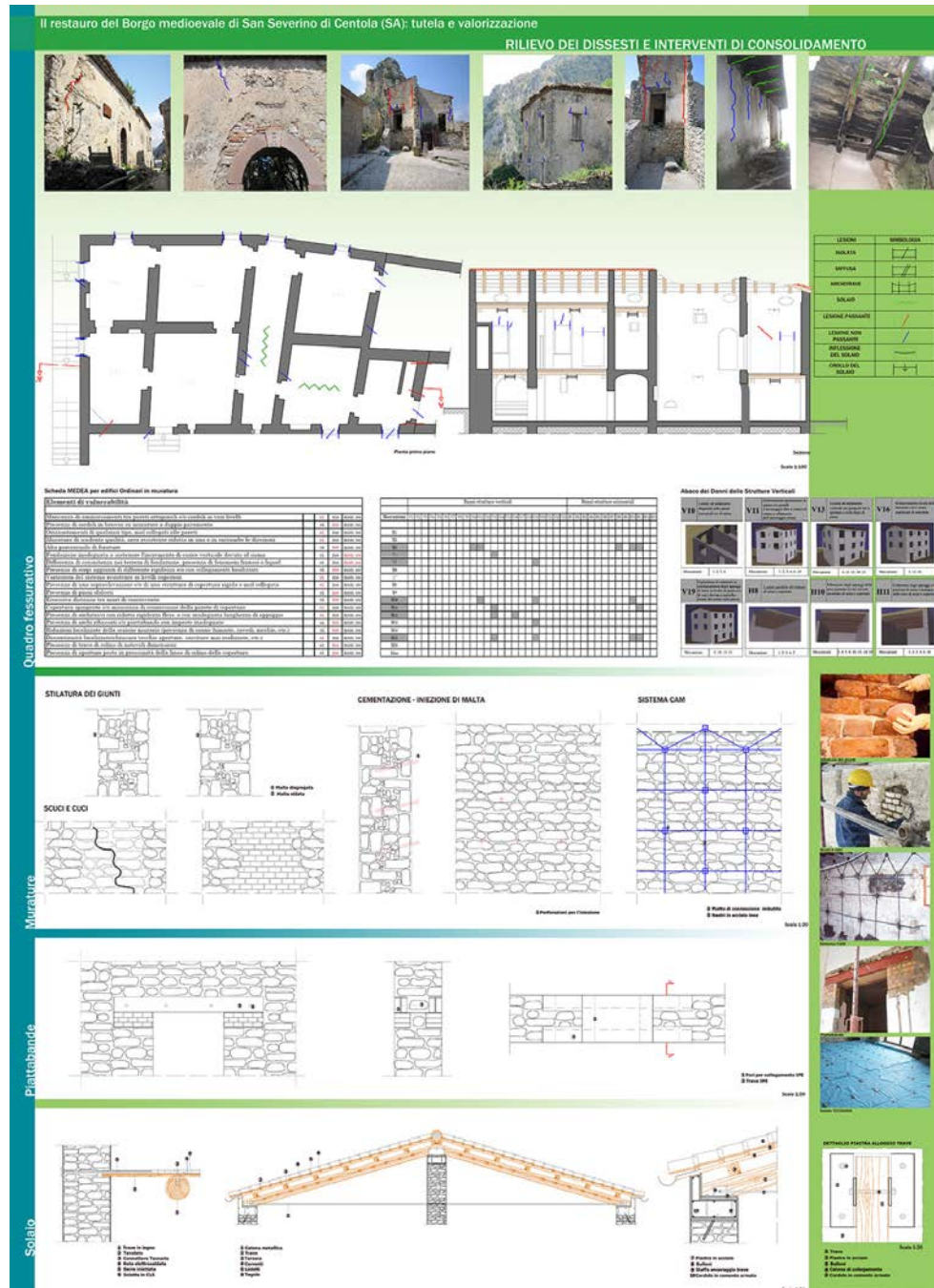
Fig. 7 – Il borgo di San Severino di Centola: rilievo dei dissesti e interventi di consolidamento
